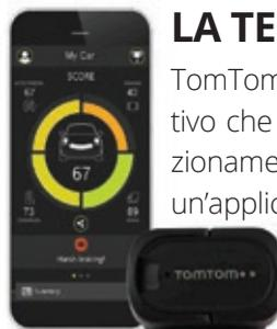
TomTom ha lanciato il Curfer, un dispositivo che monitora le prestazioni e il funzionamento dell'auto e trasmette i dati a un'applicazione per lo smartphone. Può essere montato facilmente su quasi tutte le vetture prodotte dopo il 2011.
